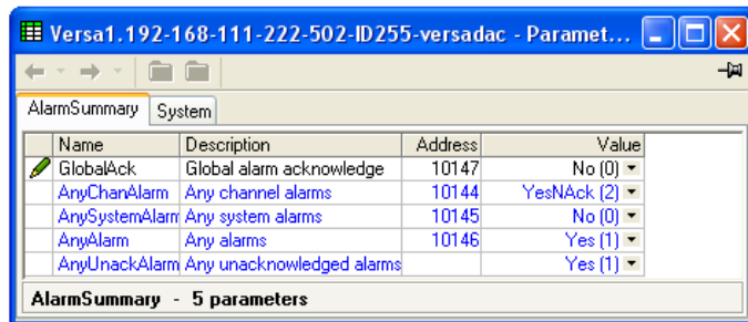
Figure 126 Menu Alarm Summary du niveau supérieur
