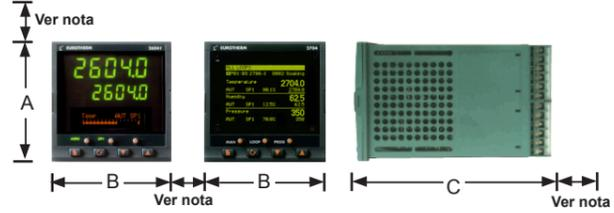
**Nota:** Deje siempre espacio suficiente para la ventilación y las conexiones.
