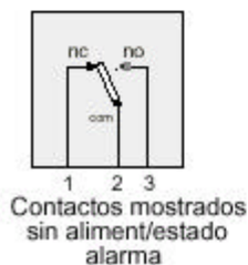
Figura 2.2.1.b Detalles del cableado de los relés
