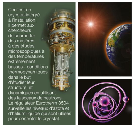
Ceci est un cryostat intégré à l'installation. Il permet aux chercheurs de soumettre des matières à des études microscopiques à des températures extrêmement basses - conditions thermodynamiques dans le but d'étudier leur structure, et dynamiques en utilisant des faisceaux de neutrons. Le régulateur Eurotherm 3504 surveille les niveaux d'azote et d'hélium liquide qui sont utilisés pour contrôler le cryostat.
