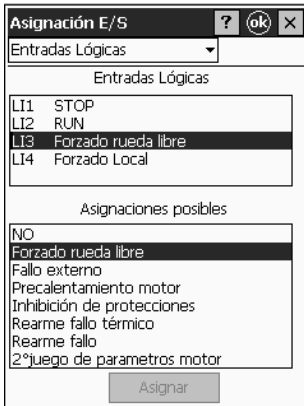
Asignación de las entradas lógicas con PowerSuite en PPC.
