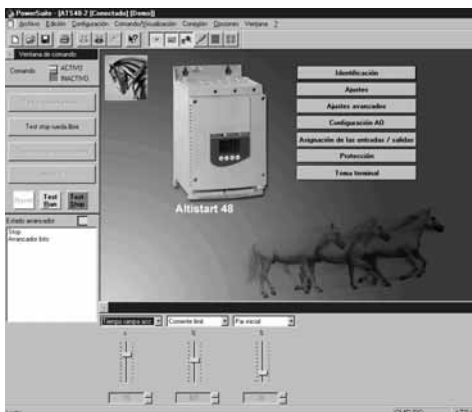
Visualización de los controles y los ajustes con PowerSuite en PC.
