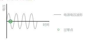
EPack 控制器能准确地检测到电压波形上的过零,并能在此时触发晶闸管。这将减少谐波失真和射频干扰,减少直流分量,并准确响应功率需求。
