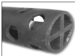
**Bien ventilée et ouverte à son extrémité, la sonde est conçue pour réduire les inconvénients dus à la suie. L'alliage utilisé pour la sonde réduit l'effet catalytique sur le méthane libéré, ce qui donne une lecture de l'atmosphère plus représentative.**
