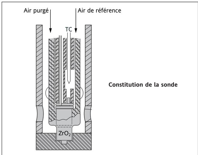
La sortie (en mV) de l'oxygène dans la sonde est donnée par l'équation de **Nernst** :
