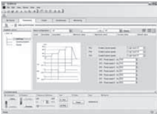
Einstellen der Vorwahlfrequenzen mit der Inbetriebnahmesoftware SoMove
