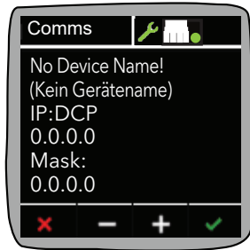
Abbildung 39 E-Pack „Comms“-Bildschirmanzeige im Lieferzustand (GeräteName = „“, IP-Konfiguration = null).
